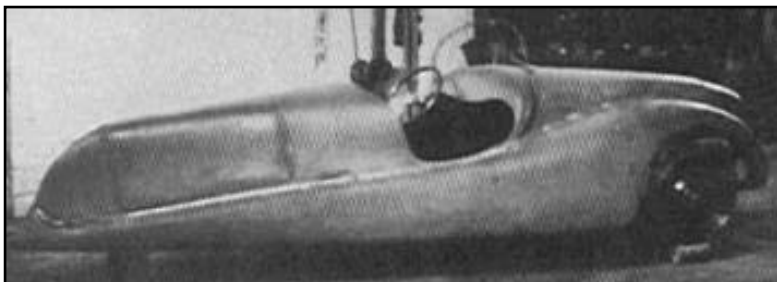
Primer prototip del Sr. Tachó. Anomenat Balena, en un principi, disenyat amb tres rodes.
