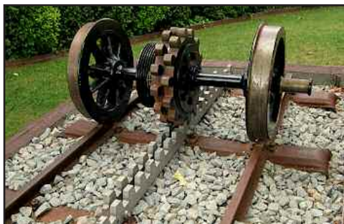
Detall del tercer carril dentat sistema A.B.T.
