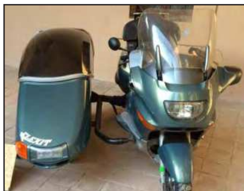
BMW K1200LT side Flexit, amb xassis oscil·lant
