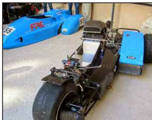
Side F1 Suzuki amb chasis monocasc LCR
